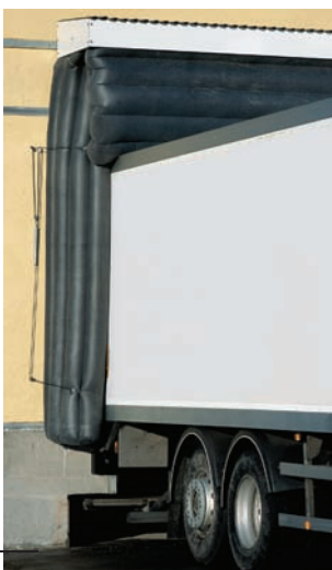
1 Accostage du camion avec le sas en position gonflée Fahrzeug an der Rampe, Torabdichtung aufgeblasen
